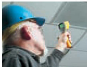
Отопление/вентиляция/ кондиционирование воздуха/холодильные установки Утечки в воздуховодах Термостаты Баланс температуры Парораспределительные системы Компрессорные линии
